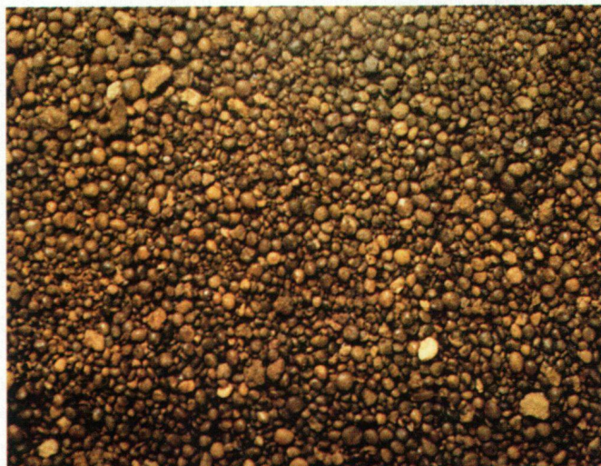
Abb. 43 Vom Ausgräber ausgewaschene Erzkörnchen, Oolithe genannt, mit einem Durchmesser um 0,5 mm.
