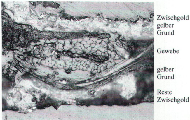
Abb. 10 Banner aus der Burgunderbeute. Queranschliff von einer der Proben aus der Lilie mit den verschiedenen Schichten.
