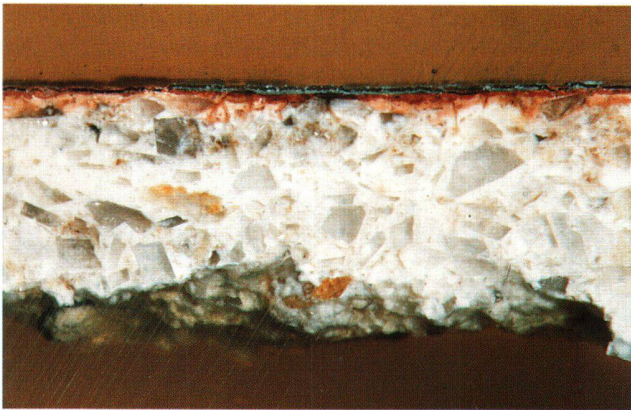
Fig. 9 Saint-Antoine, fragment 22, bordure verte sur fond rouge appliqués sur une fine couche de tuileau, stratigraphie. Démonstration de la différence de finesse de la charge pouzzolanique par rapport à la charge inerte. Macroscopie, gross. sur dia 24 x 36 mm: 4 fois.
