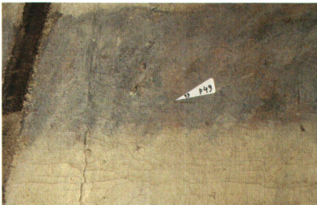
C Karton IV: Naht [N4], Gewebeteile [GT6] (links) und [GT4] (rechts), Höhe y = ca. 260 cm; Entnahmestelle der Probe 49. Detailaufnahme, Länge des Pfeils = 24 mm.
