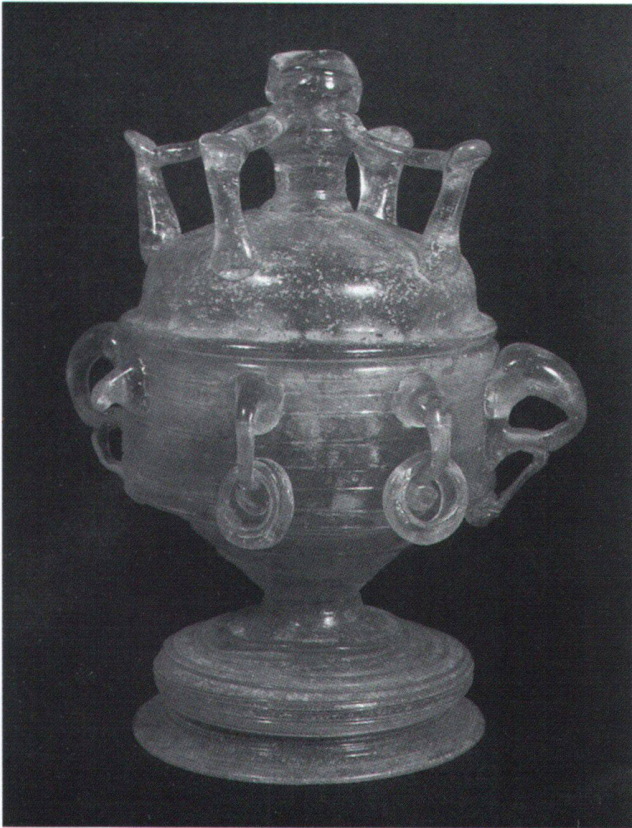
Abb. 13 Fusschale mit Deckel, 18. Jh. Stark angegriffenes Glas; ausgeprägtes Rissbild mit dichtem Rissmuster, Gelschichtschollen heben sich von der Glasoberfläche ab, grösstenteils bereits abgewischter, ursprünglich wohl flächendeckender Schleier (Ablagerungen). Zürich, Schweizerisches Landesmuseum.
