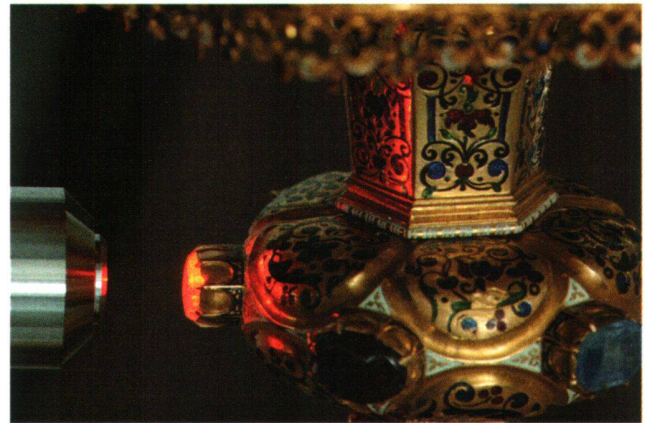
Fig. 3 Analyse par spectrométrie Raman en utilisant le laser rouge (633 nm) d'un saphir du ciboire.
