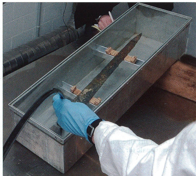
Abb. 8 Aluminiumgefäß mit zwei Querstangen, auf welchen der Degen ruht. Die Lösungsmittel werden durch einen geerdeten Schlauch eingebracht.
