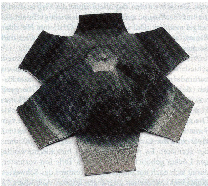
Abb.8 Nachbau des Oberwiler Degens, 2013. Zwischenstufe Knaufkappe.
