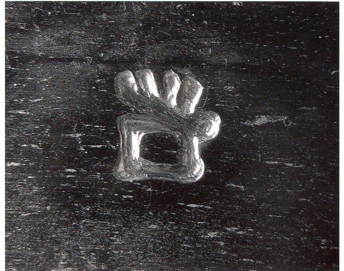
Abb. 3 Nachbau des Oberwiler Degens, 2013. Mit Zinn ausgefüllte Schmiedemarke.
