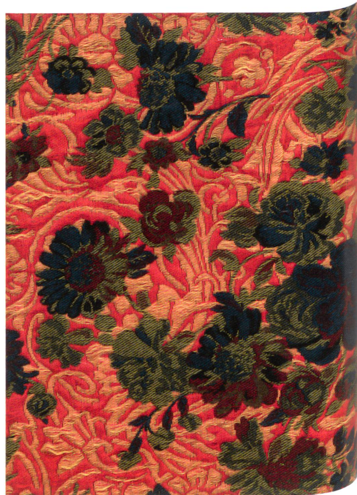
Abb. 38, 39 Archiv-Nr.581: Jacquardgewebe, Doubleface. Materialmischung (43 % Polyacryl, 36 % Acetat, 21 % Wolle), 1980–2005.
