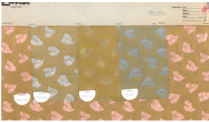
Abb.1 Archiv-Nr.351: Schafsgewebe, Leinwandbindung, Druck. Nylon (Polyamid), ca. 1940.
