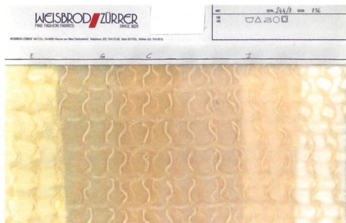
Abb.35 Archiv-Nr.602: Schaftgewebe, Leinwandbindung, Lancé. Keine Materialangaben, 1980–2005.
