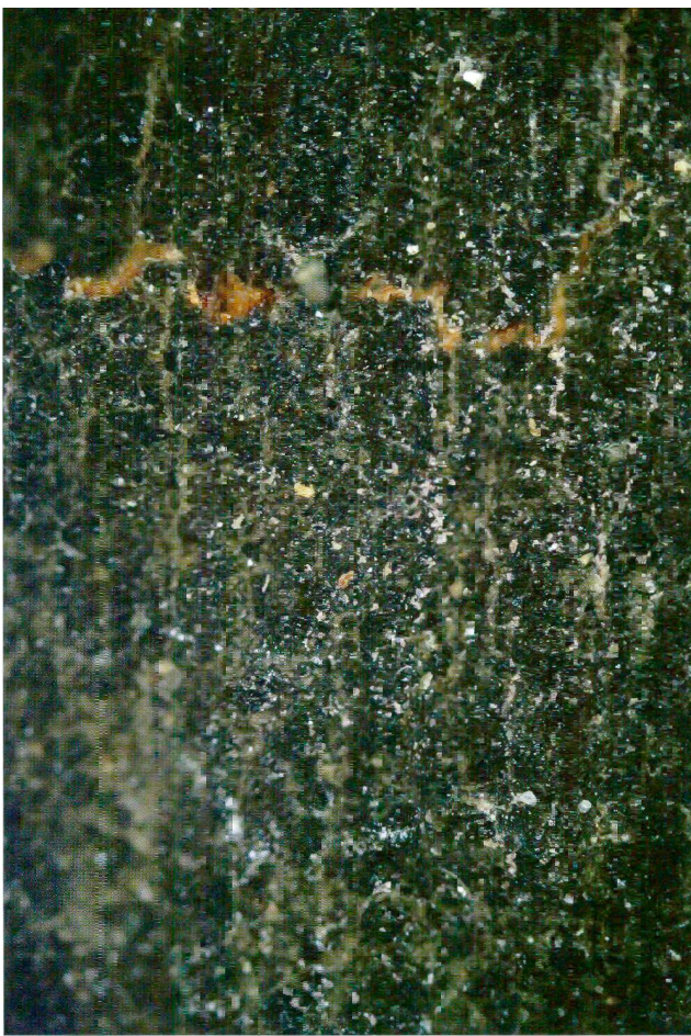
Abb.6 Raum 2.5/2.6 1304 (d), Probe mit einem sehr feinen und deckenden schwarzen Anstrich mit Craquelé. Schwyz. Gütschweg 11/13. Oberfläche in 50-facher Vergrösserung. Auflicht.
