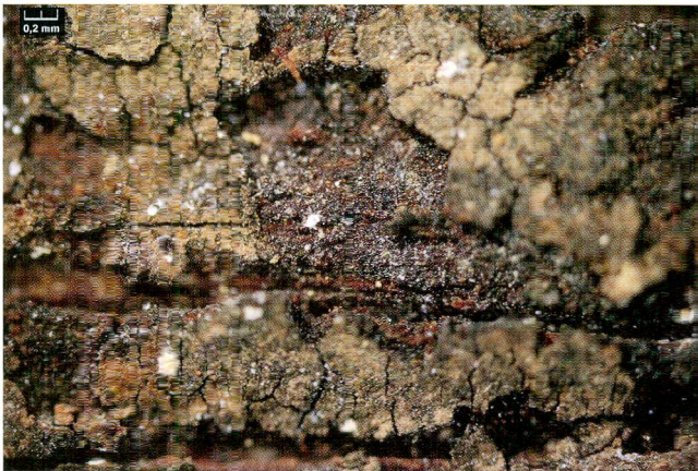
Abb.10 Westwand von 1280 (d), Probe mit zwei Anstrichen, der obere mit deutlichem Craquelé. Schwyz, Dorfbach 8, EG. Oberfläche in 50-facher Vergrößerung, Auflicht.
