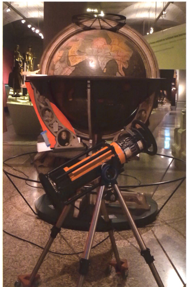
Abb. 9.1 Mobile Röntgenröhre für die Radiografie durch Thomas Becker, Art Conservation, im Auftrag der Stiftsbibliothek St. Gallen. Ein Röntgenfilm (rot) befindet sich auf der Rückseite der Korbstrebe.
