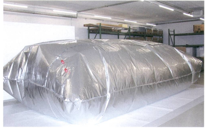
Abb. 10 Stickstoffbehandlung der Objekte in einem Stickstoffzelt. Sammlungszentrum Affoltern am Albis.
