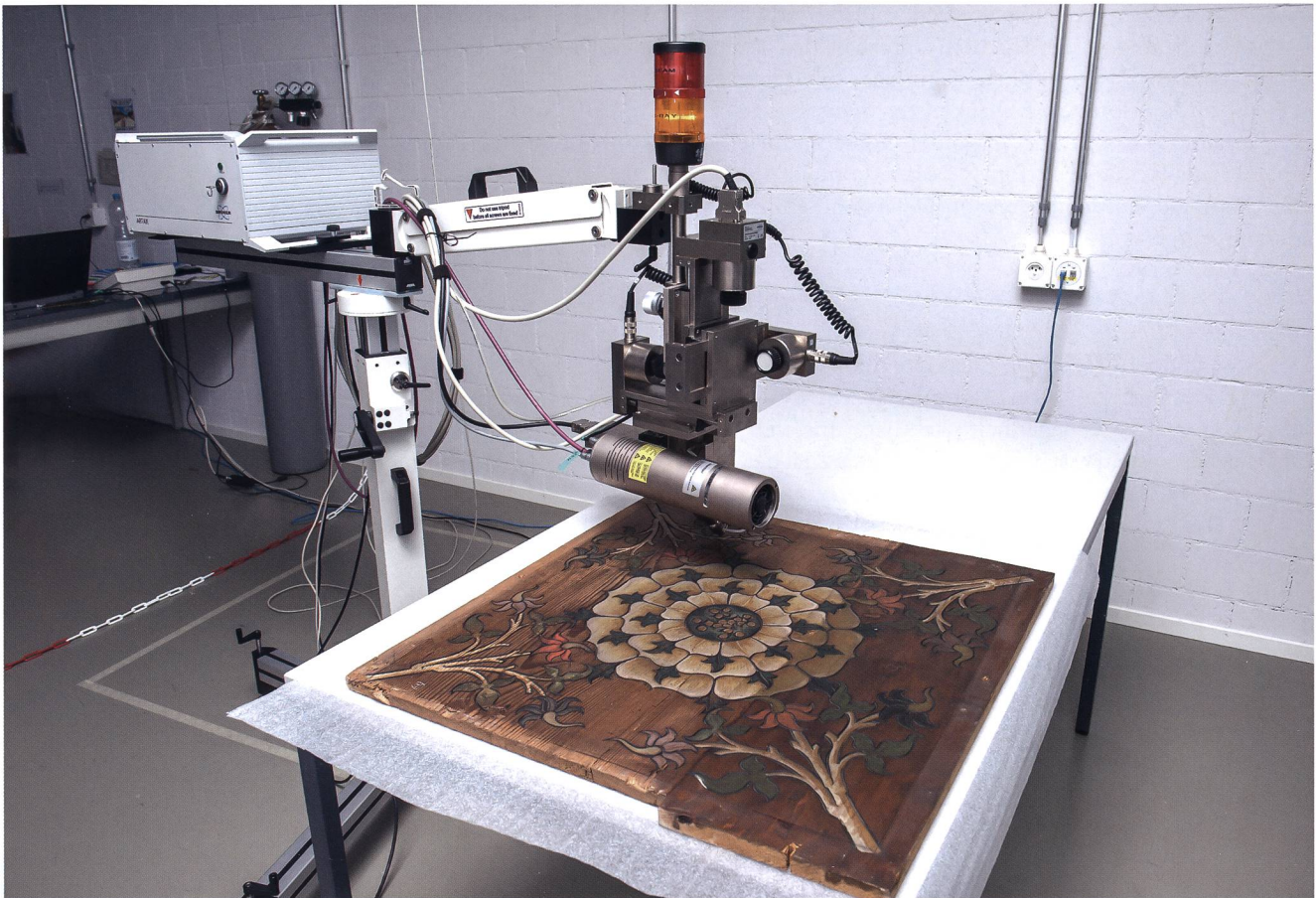
Abb. 38 Analyse eines Deckenfeldes der Decke aus dem Schloss Arbon mittels \mu -XRF zur Bestimmung der in der Malerei verwendeten Pigmente. Sammlungszentrum, Affoltern am Albis.
