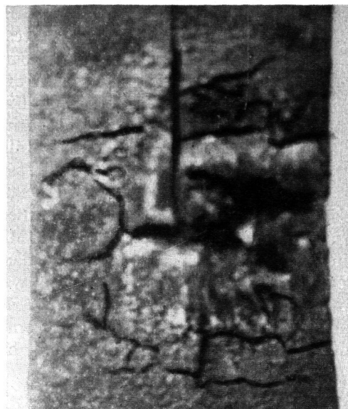
Fig. 7. Brettunterseite mit Anstrich nach 22 Minuten Brenndauer
