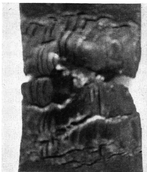
Fig. 6. Unterseite des imprägnierten Brettes nach 37 Minuten Brenndauer.
