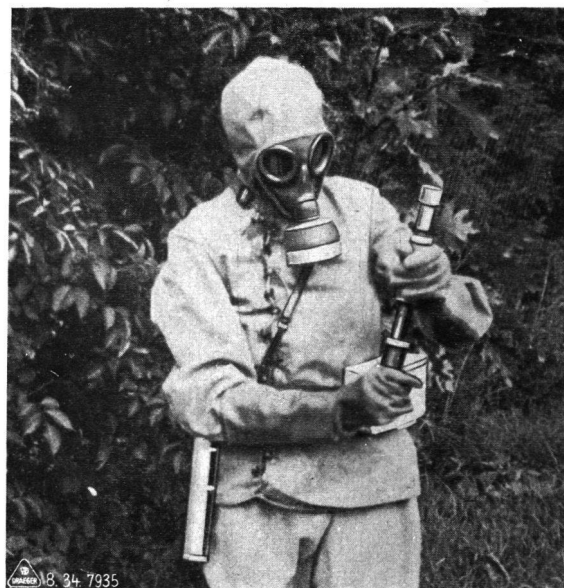
Bild 8. Gasspürer untersucht mit DS-Gerät eine Bodenprobe. Le chercheur de gaz prend une épreuve du sol avec l'appareil DS.
