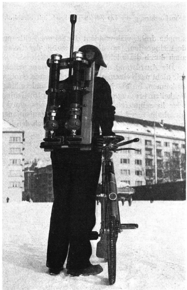
Schnelllöschtrupp der LO Zürich (Hydrantengarnitur)
