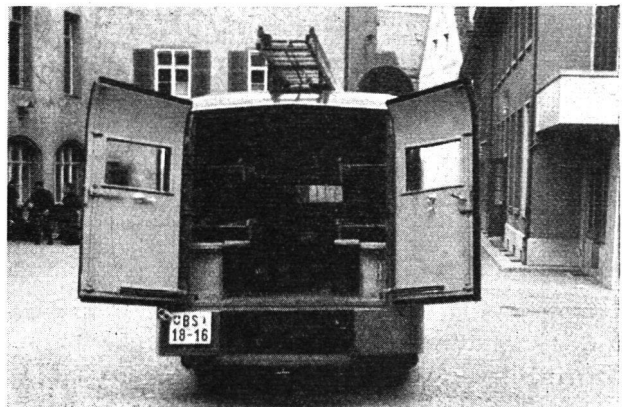
Abb. 15. Inneres als Sanitätswagen eingerichtet. Die Bahren gehören zur Wagenausrüstung und sind in wenigen Minuten montiert.
