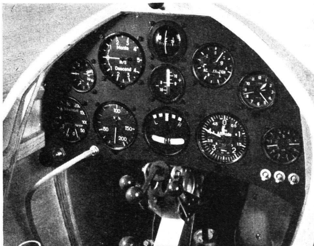
Einbau von Präzisions-Bordgeräten im schweizerischen Leistungssegelflugzeug «Moswey III».
