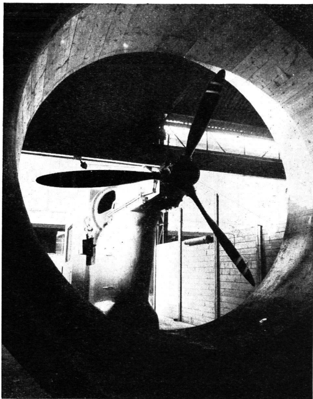
Dynamischer Ausbalancierstand von Escher-Wyss. Auf diesem werden die fertigen Propeller nicht nur statisch, sondern auch auf dynamische Umbalancen im Lauf geprüft.
