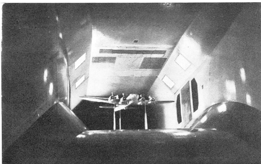
Der Windtunnel für grosse Luftgeschwindigkeiten der Boeing Aircraft Company in Seattle (USA.). Ungefähr 9000 Windtunnel-Versuche wurden während der Entwicklungsphase der bekannten, durch die Boeing-Werke hergestellten Superfestungen B-29 durchgeführt. Das Bild zeigt ein naturgetreues Modell einer «Fliegenden Festung» im «Wind-Examen».
