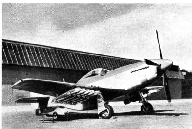
Mustang-Jagdflugzeug mit 8-cm-Pulverraketen Oerlikon bewaffnet
