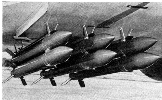
Der DRAKEN mit 12 Bofors-Raketen des Kalibers 13,5 cm bewaffnet. Unter jedem Flügel sind je sechs solcher «Air-to-ground»-Raketengeschosse, d. h. Luft/Boden-Angriffsraketen angebracht. Mit andern Worten: Der DRAKEN mit Erdkampfbewaffnung.
