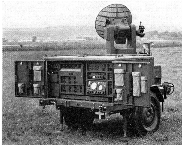
Das Feuerleitgerät zum 35-mm-Flabgeschütz. Hauptelemente: Richtgerät, Radar-Anzeigegerät, Rechenggerät, Fahrwerk.
