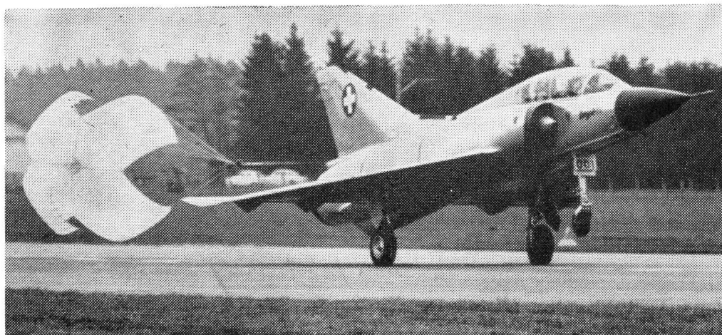
Unser Bild zeigt den ersten Mirage bei der Landung mit Zuhilfenahme des Bremsfallschirms
