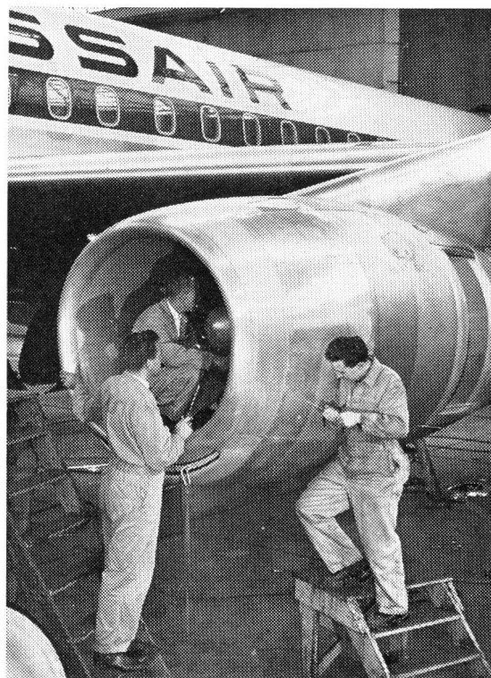
Die Triebwerkrevision des SAS — und für die DC-8 auch der Swissair — wird nicht in Kopenhagen selbst, sondern in Stockholm vorgenommen. Die Motoren werden nach erfolgter Prüfung auf dem Landweg nach Dänemark gebracht und im Rahmen der Gesamtrevision eingebaut
