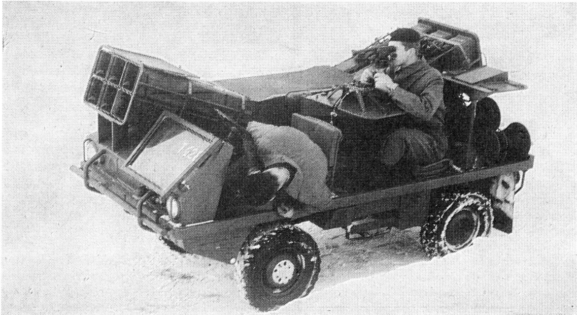
Der leichte, zu einem hocheffektiven Panzerkämpfer verwandelte Mannschaftsgeländewagen Puch-Haflinger. Bei Feuerbereitschaft aus dem Marsch können in etwa fünf Sekunden je 6 Raketen nach vorn oder nach hinten abgefeuert werden.
