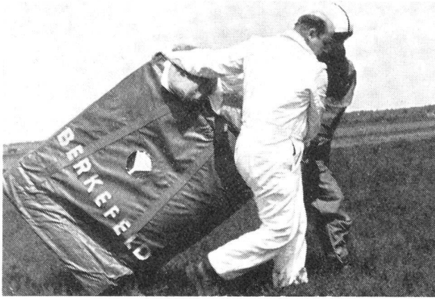
Mit Fallschirm wird im Katastrophengebiet ein kleineres Wasseraufbereitungsgerät abgeworfen, während gleichzeitig die Bedienungsmannschaft mit Fallschirmen abspringt, den Apparat zum Einsatzort abschleppt, wofür sich am Transportbehälter Kufen befinden.
