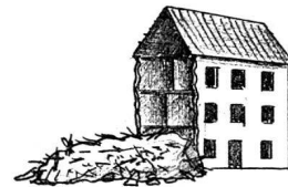
Abb. 1. «Klassisch schöner» Trennschnitt, vor dem Restgebäude kompakter, ausbildungsmässig uninteressanter Trümmerhaufen.
