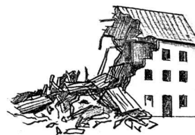
Abb. 2. Wirklichkeitsnaher Abriss vom Restgebäude, mit Hohlräumen und Schadenelementen durchsetzter Schutthang.
