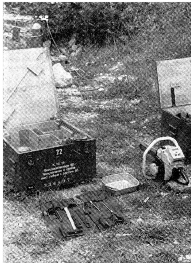
Abb. 13. Benzinkettensäge, gegen Trennschleifer auswechselbar
