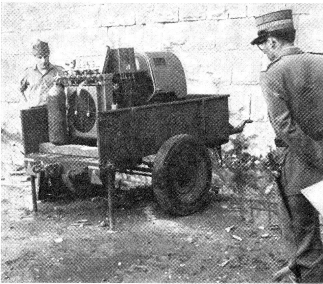
Abb. 12b. Frischluftkompressor auf Werkzeuganhänger montiert
