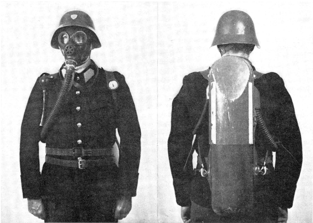
Abb. 10a. Pressluftatmer: Masken, Atemschlauch und Manometer (links)
