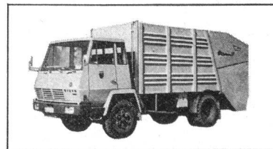
4) Steyr: 990 Kehrichtwagen Motor: Steyr WD. 614.01 Getriebe: Allison MT-41 (Automat)
