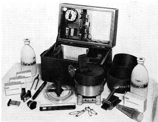
IDOS-Tageslichtbox, welche die Entwicklung von 100 bis 200 Filmblättern pro Stunde zulässt und sich z. B. für Einheiten, kleine Gemeinden oder Betriebe der Landwirtschaft eignet.
