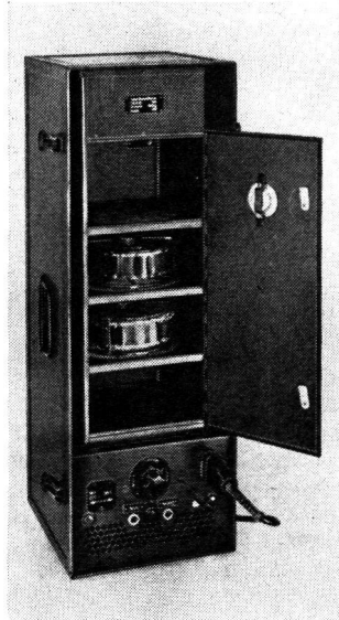
Mit den hier gezeigten Geräten der Massenauswertung der Filme, bis 3000 pro Stunde, bildet der Recorder das letzte Glied in der Kette. Die Strahlenmessergebnisse der Filmstreifen können hier auf ein Papierband übertragen werden.
