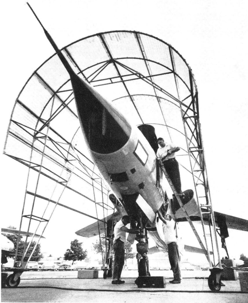
Flugbereitschaftskontrolle eines F-105 unter einem fahrbaren Schutzdach.
