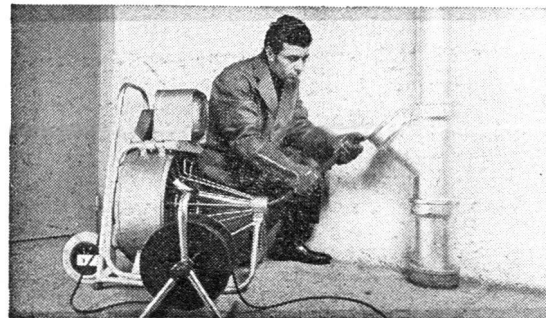
Entstopfer Typ A20 für Rohre von 50–300 mm \varnothing und bis zu 30 m Länge.
