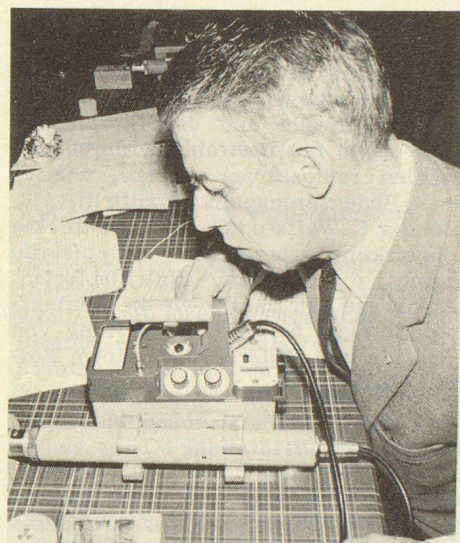
Laborübung: Messung radioaktiver Präparate mit dem Universal-Strahlungsmessgerät EMD 2 (Einkanaldiskriminator mit Szintillationssonde)
