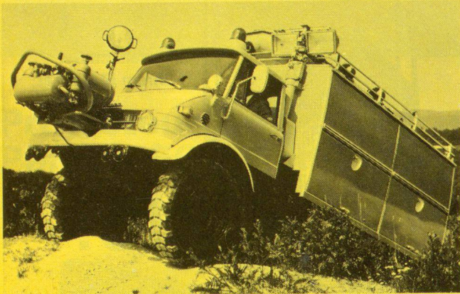
Rüstwagen RW 1. Fahrzeug für technische Hilfeleistungen.
