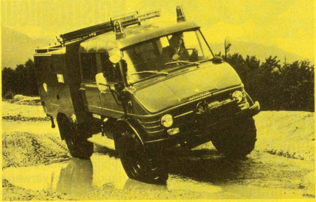
Tanklöschfahrzeug TLF 1300. 6-Mann-Kabine, kombinierte Normal- und Hochdruckpumpe, eingebauter Schaummitteltank.
