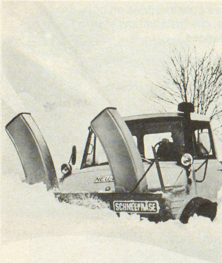
Die Unimog-Zapfwellenschneefräse schafft bis zu 2500 m 3 /h. Durch die Schnellwechseinrichtung ist sie in Minuten gegen eines der nebenstehenden Geräte ausgetauscht.
