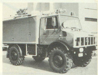
Unimog U 1700 (168 PS), ausgerüstet als Schlauchwagen für die Flugplatzfeuerwehr Kloten.
