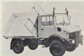
Abb. 1. Unimog U-1000 L (125 PS), Radstand 3250 mm, Gesamtgewicht 7500 kg, Schweizer Kippbrücke bis 2800 mm. (Robert Aebi AG, Zürich)
