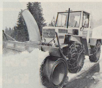
Abb. 2. MB-trac von Daimler-Benz, ein überwiegend aus erprobten Unimog-Aggregaten konzipierter Allradschlepper, mit Vorbau-Schneefräse. (Robert Aebi AG, Zürich)
