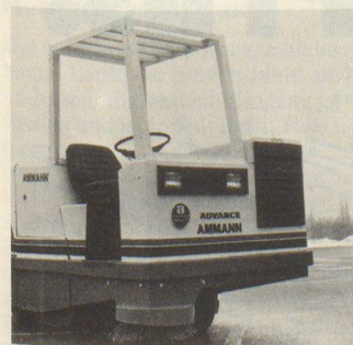
Neu im Ammann-Programm: Advance-Kehrsaug- und -Nassschrubmmaschinen für Flächenleistungen von 1400 bis 14000 m 2 pro Stunde.
