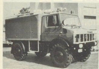
Unimog U 1700 (168 PS), ausgerüstet als Schlauchwagen für die Flugplatzfeuerwehr Kloten.
