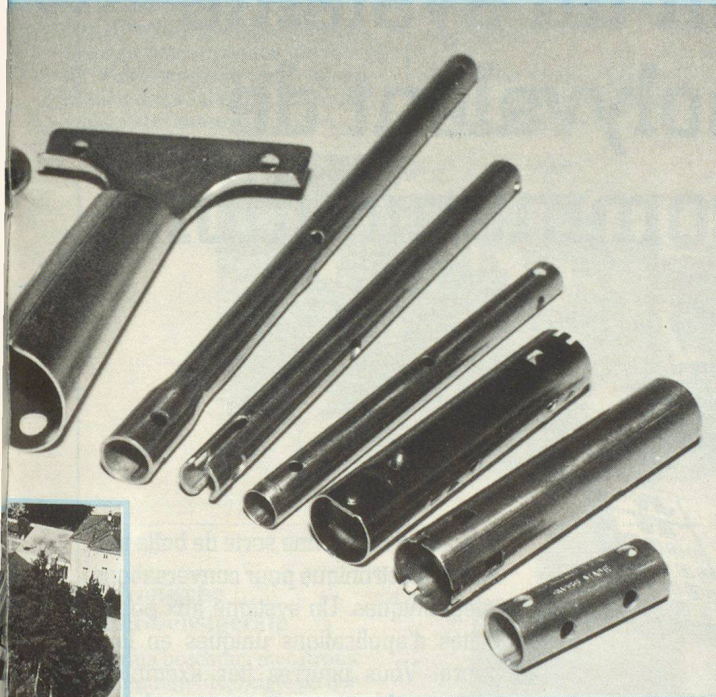
Eine Spezialität – stanztechnisch gefertigte Rohre.
