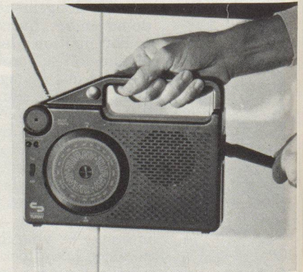
SR-Radio UKW/MW, stromunabhängig, dank Handkurbel und Trockenakku
