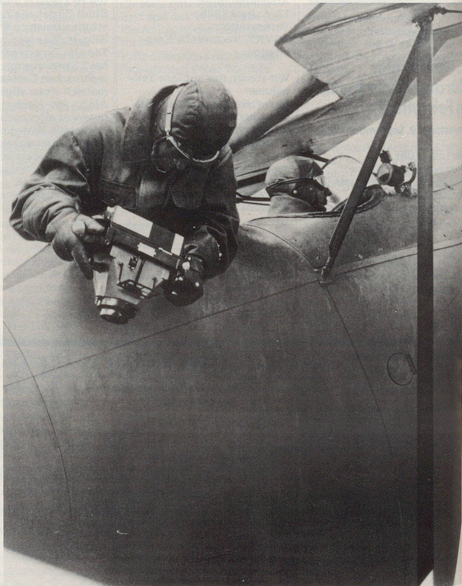
Seit 1930 verwendet die Landestopographie Luftbilder für die Erstellung und Nachführung der Karten. Unser Bild zeigt, wie aus einem offenen Vermessungsflugzeug Geländeaufnahmen geschossen wurden.
