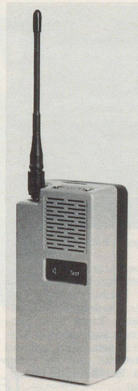
Abb. 10. Schutzraumempfänger E-662, betriebsbereit.
