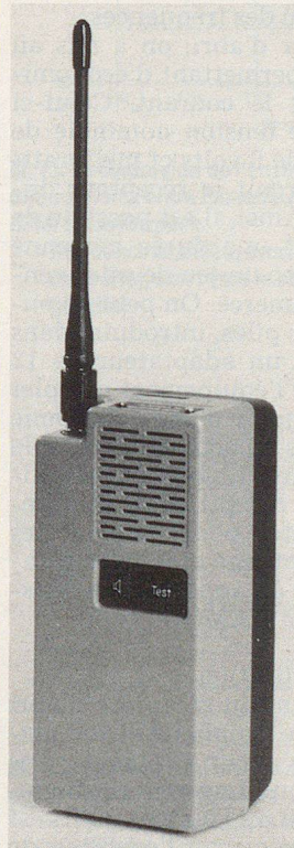
III. 10. Récepteur d'abri E-662, prêt à l'emploi.
