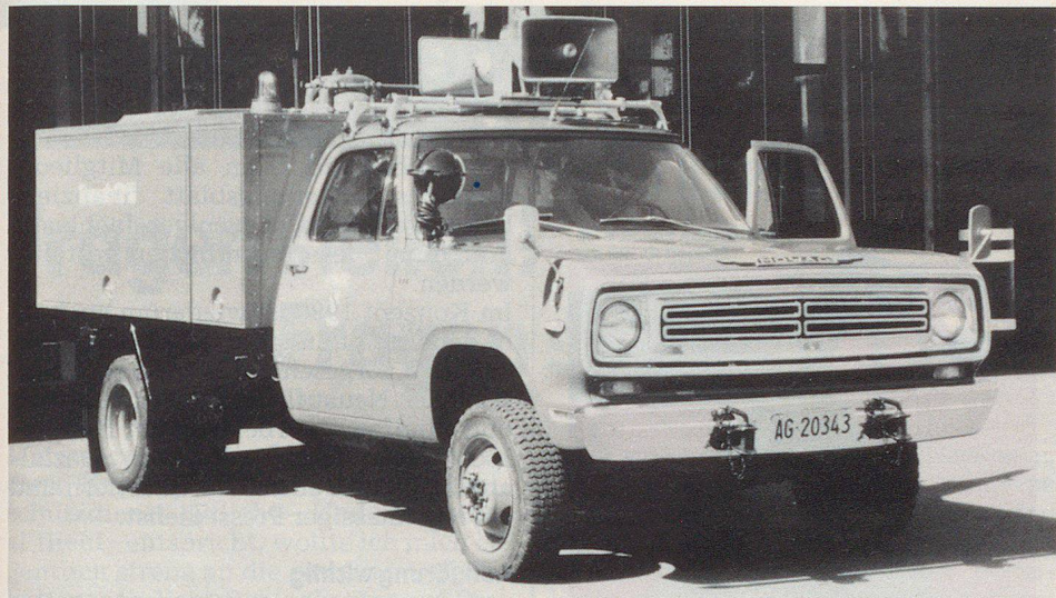
Feuerwehrfahrzeug mit montierter mobiler Sirene.
