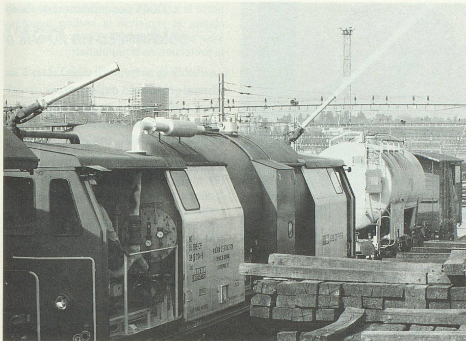
Une partie du train d'extinction avec son canon à eau...
