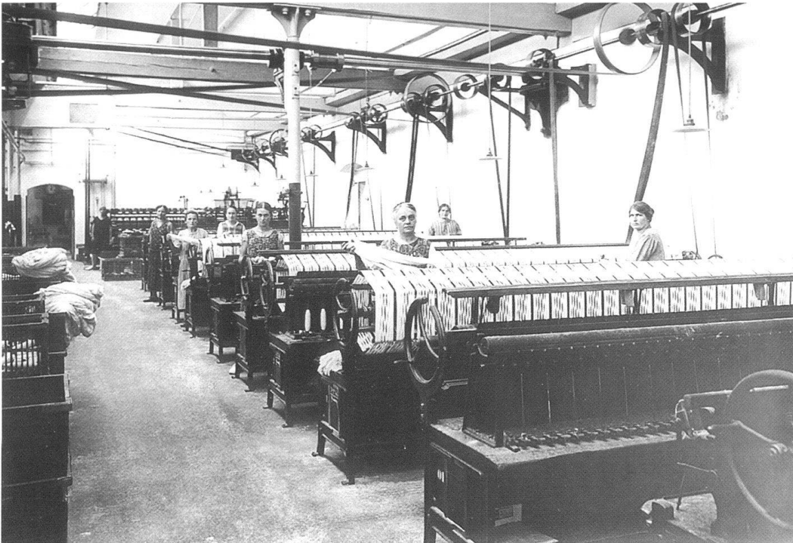
Abb. 12 Die Hasplerei in der Zwischenkriegszeit, wo die Arbeiterinnen die Maschinen bedienten, welche das Baumwollgarn aufwickelten, bevor es in die Färberei ging. Oberhalb der Maschinen ist die Transmissionsanlage sichtbar: Über Schwungräder gelangte die mechanische Energie in die Fabriksäle und wurde dort über Lederriemen auf die Maschinen übertragen.
