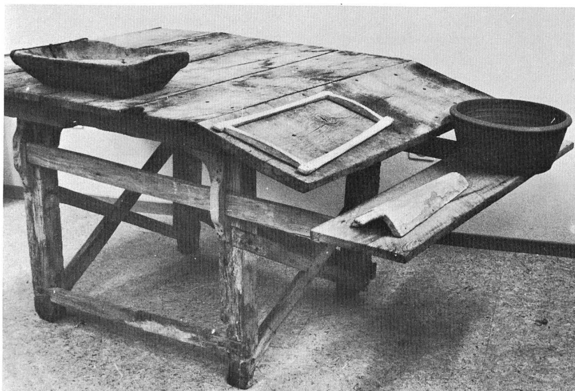
Abb. 5 Ein Arbeits-tisch mit Streich-rahmen und Formholz für die Her-stellung von Hohlziegeln; Gefäße für Sand und Wasser.
