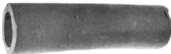
Abb. 27 Drainröhren wurden mit einer Länge von 30 cm (selten 50) und einer lichten Weite zwischen 3 und 20 cm hergestellt, von Dietwil/ AG (ZMM Reg- Nr. 1337.1)
