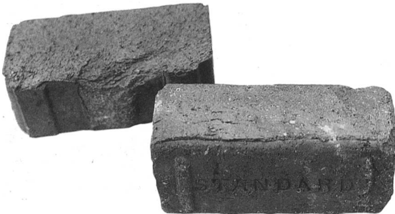
Abb. 4 Ein «paver» (paving brick = Pflaster- stein); die auf einer Seite ange- brachten Noppen erleichtern das Legen im richtigen Abstand.
