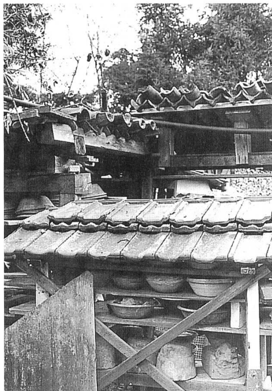
Abb. 3 Schüsseln zum Ent- wässern von Tonportio- nen und zum Lagern ein- getrockneter Tonkerne. Die Falzziegel darüber stammen gemäss Inschrift auf ihrer Rück- seite aus der Dampfziege- lei Heurieth, Zürich 1885.
